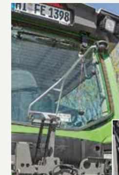
O suporte da barra superior com amortecedor de pressão de gás facilita o trabalho.
