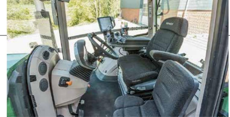
A cabina é idêntica à cabina do Vario 1000, mas tem uma suspensão de três pontos.
