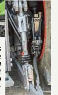
As barras inferiores podem ser facilmente suspensas e há uma escala permanente para o ajuste em comprimento.
