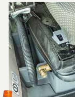
O assento é alimentado pelo sistema pneumático e já não tem um compressor próprio. Além disso, existe uma conexão para limpar a cabina por sopro de ar.
