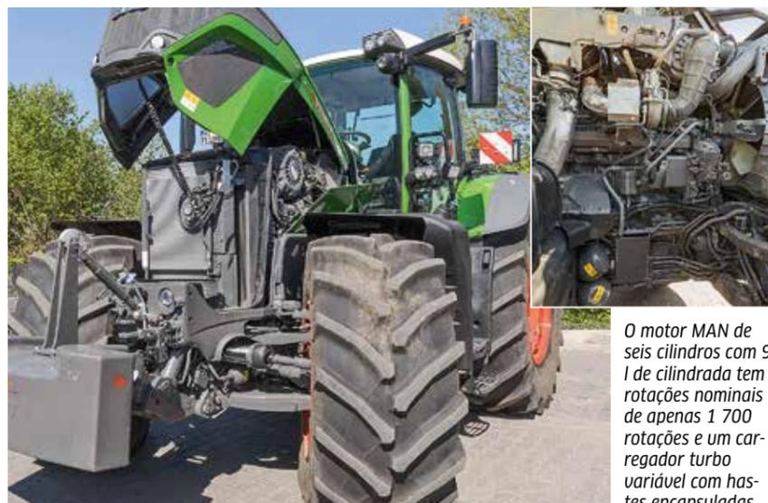
O motor MAN de seis cilindros com 9 l de cilindrada tem rotações nominais de apenas 1 700 rotações e um carregador turbo variável com has-tes encapsuladas.
