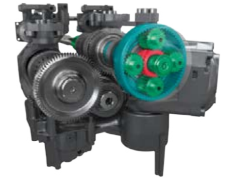
Pārnesumkārbas modeļiem, kam ir vairāk par 330 ZS, ir konstruēta vislielākajai slodzei. Tai ir četru planetāro zobratu komplekts, kas uzlabo jaudas pārvadi, iegūstot lielu spēku.
