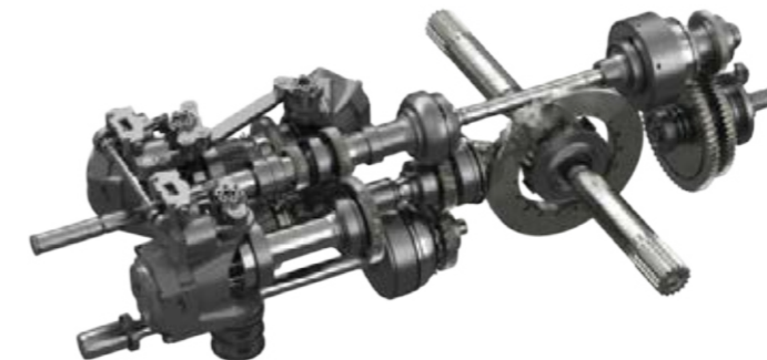
Fendt Vario transmisija ir hidrostatiski-mehāniska enerģijas sadales pārvade. Palielinoties ātrumam, caur planetāro zobpārvadu pārvadītās mehāniskās enerģijas daļa palielinās. Hidrostatu, ko var iesvārstīt par 45 grādiem, kam ir augsts darbības spiediens ar maks. 550 bāriem nodrošina lielisku efektivitāti.
