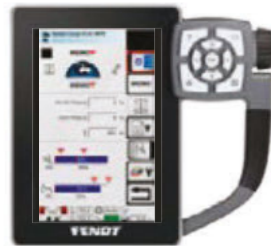
Affichage du levier en croix et du système de pesée : poids instantané et cumulé et limite de la plage de travail du brancard et de l'outil.
