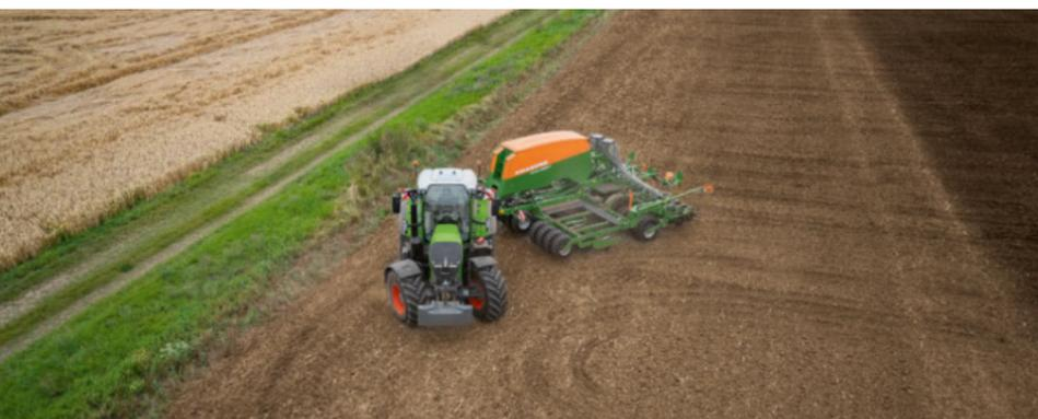
“Lo que nos dejó realmente impresionados fue la maniobrabilidad. Gracias, en parte, al efecto „pull-in-turn“ de la tracción total automática, medimos un radio de giro de solo 12,25 metros (VF600/ 70 R 30 con 1,98 m de vía): ¡Sobresaliente!”
